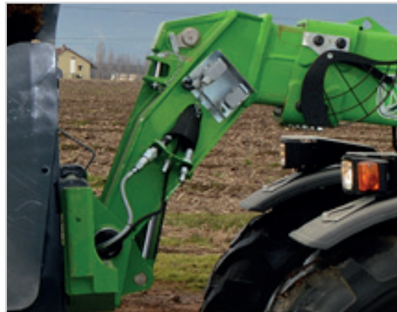
Leidingen, elektrische kabels en hydraulische hulplijnen liggen binnenin de giek.
