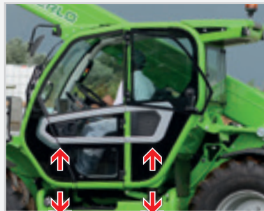
CS hydropneumatisch geveerde cabine activeerbaar door de bestuurder. Uniek op de markt.
