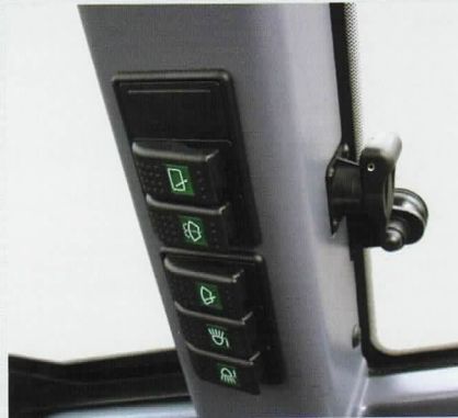
Schakelaars centraal opgesteld Stekker voor permanente 12 V stroom
