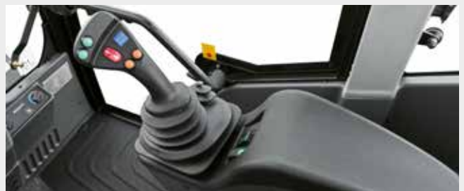
De armleuningen en de joystick vormen één geheel met de zetel en volgen dus alle bewegingen ervan. Zo blijft de bestuurder fit, zelfs na lange werkdagen.
