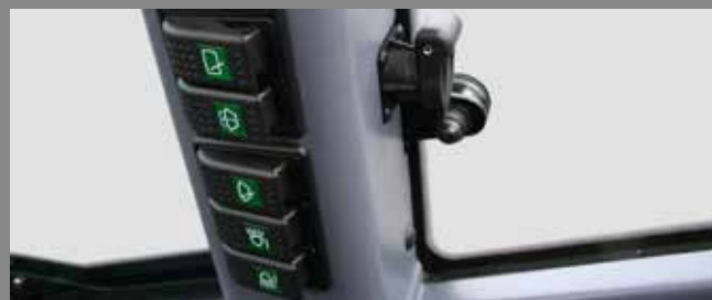
Gecentraliseerd schakelaarsveld, stopcontact met gelijkstroom
