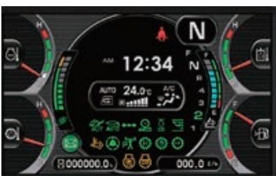
Informatie in één oogopslag: basisdashboard met LCD-monitor
