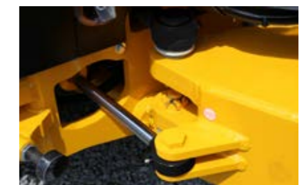
Het knik-pendelscharnier is onderhoudsvrij en uitgerust met een uitgebreide fabrieksgarantie.
