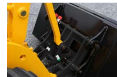
Met de gereedschapshouder „SWH“ kunnen alle opbouwgereedschappen snel aan- en afgekoppeld worden. De hydraulische vergrendeling is standaard.
